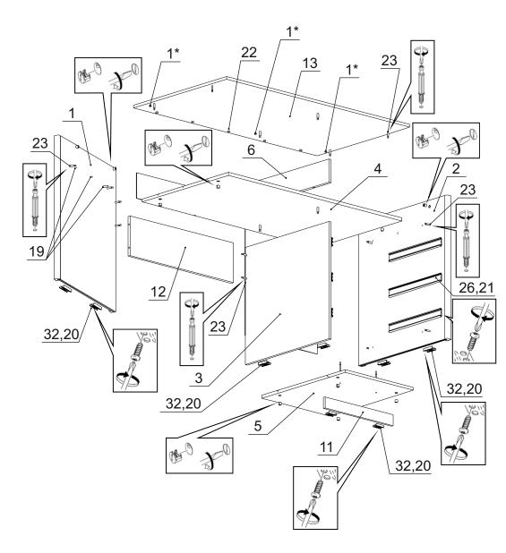
1\*. При установки модуля 987, отверстия пробить с тыльной стороны насквозь сквозным сверлом  $\varnothing$  7.
